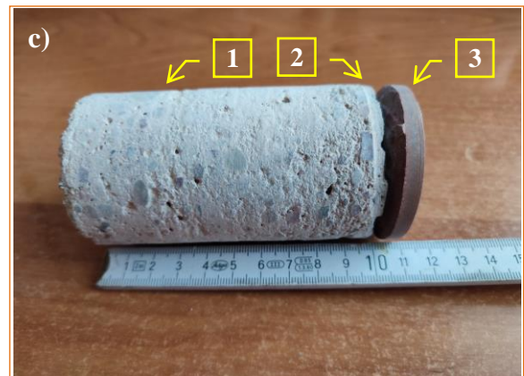
Fot. 3.3. Wycięte ze stropu nad I piętrzem odwierty rdzeniowe o średnicy 62 mm przedstawiające układ jego warstw: a), b) odwiert rdzeniowy nr 1 pobrany w usytuowanej na II piętrze sali chorych Nr 4, c) odwiert rdzeniowy nr 2 pobrany w pomieszczeniu sterowni:
